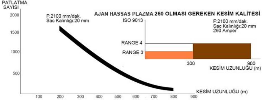
Şekil 1 – Ajan Hassas Plazma 260A Elektrod ve Nozzle Olması Gereken Ömür Çizelgesi
